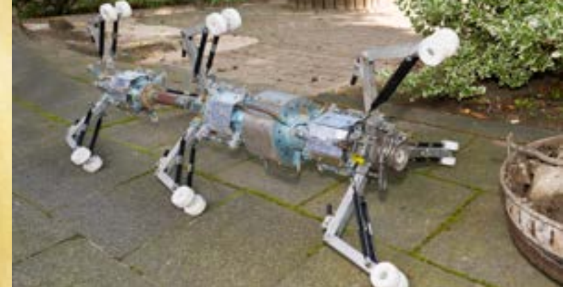
Lichterkette zur Schlauchlinieraushärtung mittels UV-Licht
