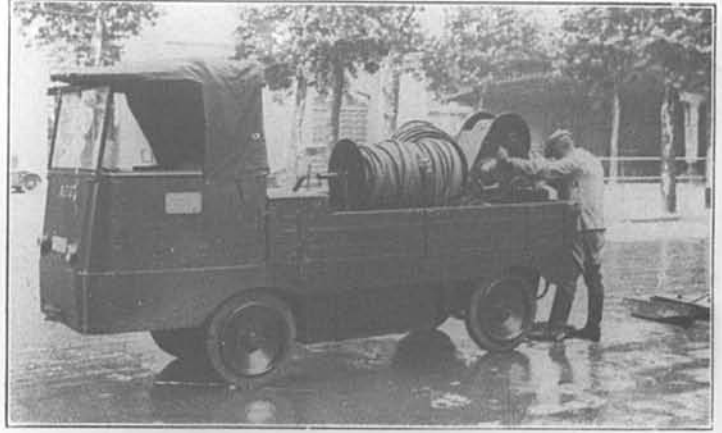
AEG Elektrokarren für Kanalreinigung
